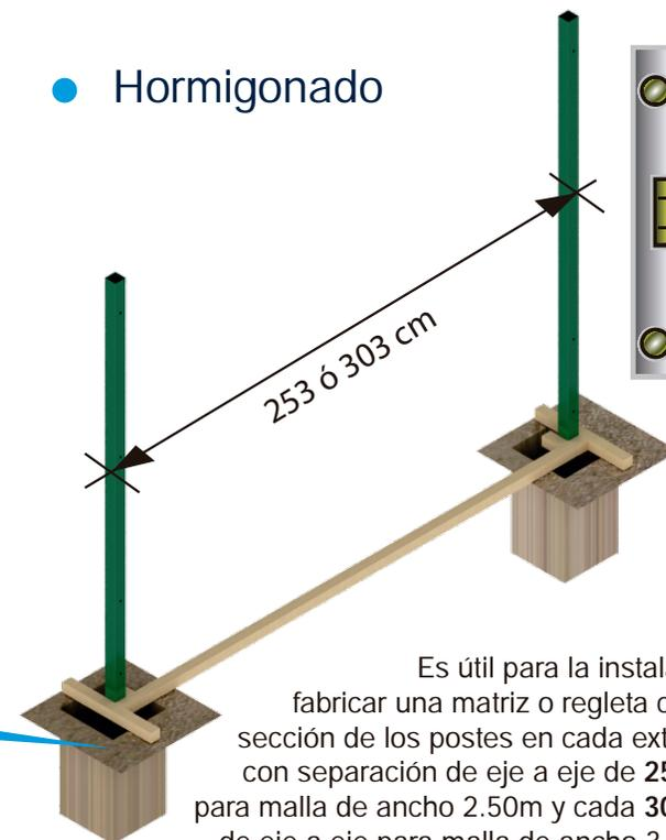
Es útil para la instalación fabricar una matriz o regleta con la sección de los postes en cada extremo con separación de eje a eje de **253cm** para malla de ancho 2.50m y cada **303cm** de eje a eje para malla de ancho 3.00m.
